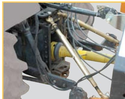
■ Tiranti stabilizzatori con supporto di fissaggio
