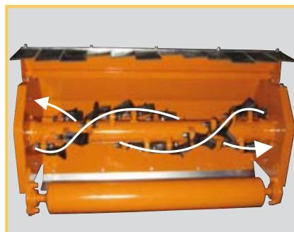
■ Reversibilità di rotazione del rotore e coltelli snodati a "Y" con maniglia
